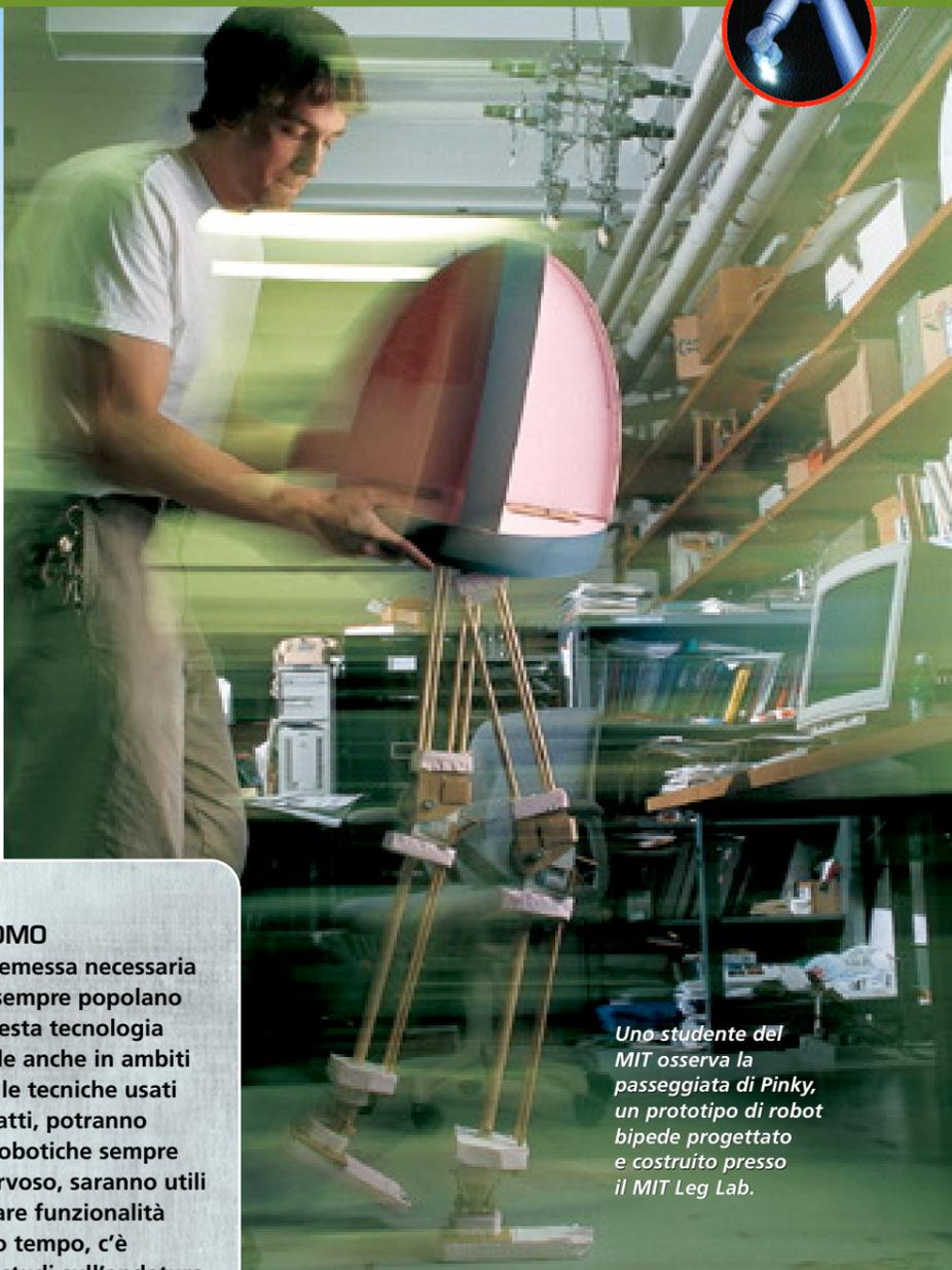
Uno studente del MIT osserva la passeggiata di Pinky, un prototipo di robot bipede progettato e costruito presso il MIT Leg Lab.
